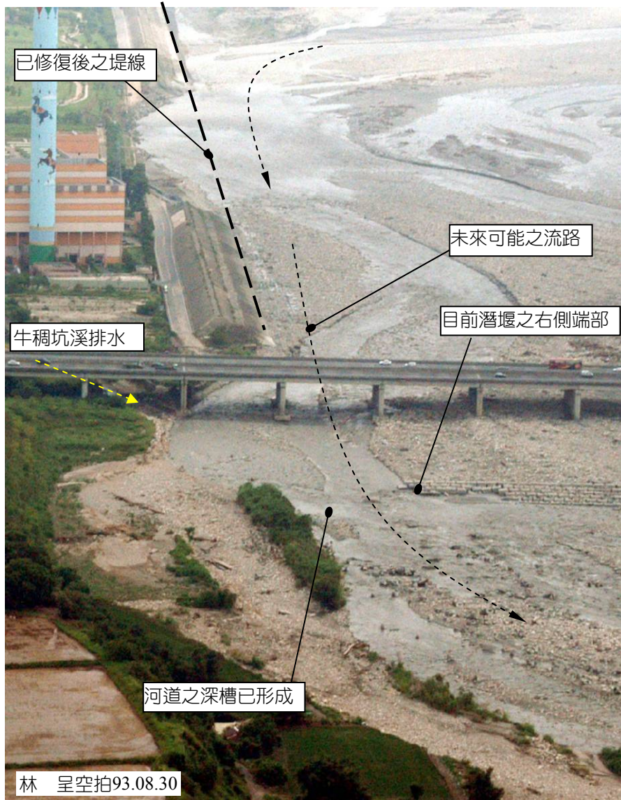
圖 4.1-22 國道一號 164K+068 大甲溪橋現況照片及歷年河床變化圖(二)
